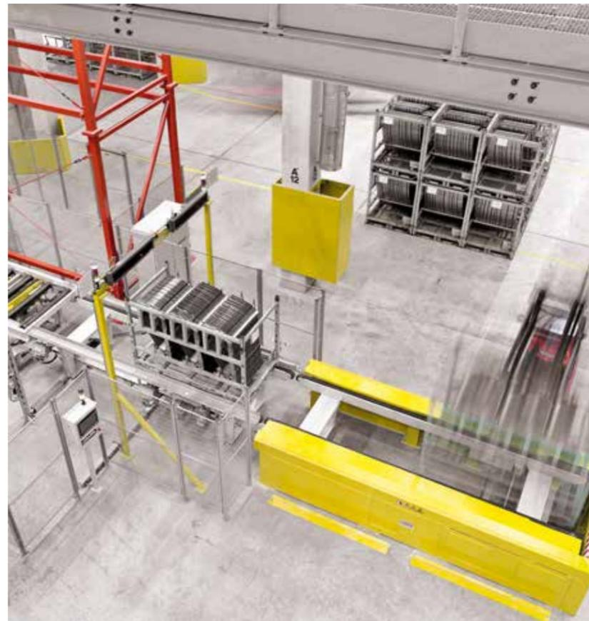
Abb.: Karosserieteile werden sicher und schnell über Racks an ihren Bestimmungsort transportiert.
